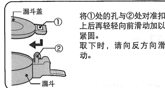
将①处的孔与②处对准扣上后再轻轻向前滑动加以紧固。
