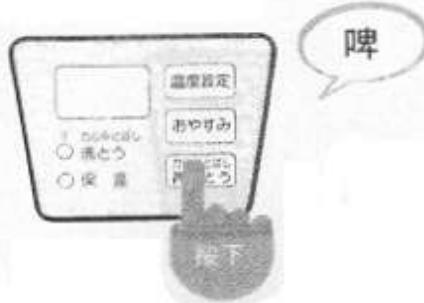
● 設定定時以後按下 **再沸騰/除漂白氣味** 鍵，自動取消定時作用。此時壺裏的水溫已高就變成保溫狀態，還低時變為沸騰而繼續加熱。
