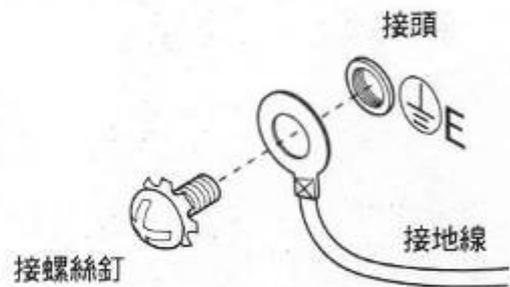
2 本機已附有接地線請自行接至大樓之共同接地線端避免發生漏電。
