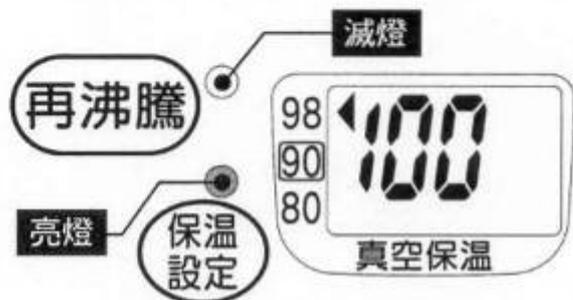
熱水溫度約98°C時，溫度表示變換。
