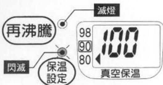
熱水溫度約80°C時，溫度表示變換，保溫燈從閃滅切換為亮燈。
