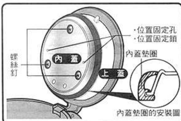
零件名稱：內蓋墊圈 零件號碼：626053-00
