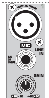
图 2.1: Mic/Line 输入端的接口和调节器
