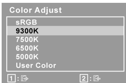
**sRGB-** 是一种颜色管理的工业标准，它支持很多最新的应用程序。启用此设置，LCD 可以更精确地显示原始色彩。启用 sRGB 设置后将关闭 Contrast( 对比度 ) 和 Brightness( 亮度 ) 调整。
