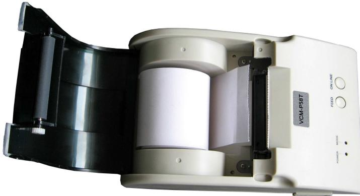
3) 将纸头穿过打印机上盖的出纸口，合上打印纸仓盖。
