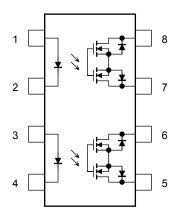
1, 3 : Anode 2, 4 : Cathode 5 : Drain D1 6 : Drain D2 7 : Drain D3 8 : Drain D4
