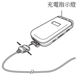
1. 打開外部端口 / 手機充電端口的護蓋，插入充電器的接口。
