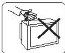
请勿将异物(如:铁屑、螺钉、硬币等)插入机内,以防引起电路短路着火,损坏电视机。
