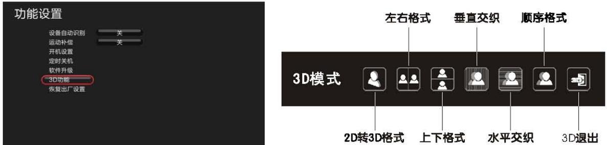
方法3：在电视/视频/YPbPr/HDMI/USB/网络的在线播放/我的收藏下，按遥控器上的“3D”键，显示“2D转3D格式”、“左右格式”、“上下格式”、“垂直交织”、“水平交织”、“顺序格式”、3D退出功能相对应的图标，按OK键进入。如用户选中2D转3D格式的图标，进入后会提示2D内容转成3D内容后的景深选择，有“低”、“中”、“高”可选。
