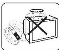
电视机应远离扬声器、电动机、变压器等磁性物品，以免引起彩色异常。
