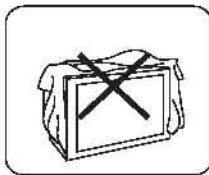
在开机看电视时，电视机上不可覆盖织物等影响散热物品，以防造成电视机散热不良，直接影响电视机使用寿命或引起故障，甚至着火。盖电视机罩时务必确认拔掉电源插头。
