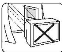
电视机严禁雨淋、受潮和严重的灰尘侵蚀，以防引起触电或电路短路着火。
