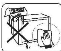
勿用酒精、氨水、稀释剂等清洗电视机表面，若确有必要，请用湿海绵或软布(可加少量中性洗涤剂)拧干后清洗，并切记在清洗前切断电源。
