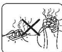
应根据电视机的电源消耗功率选择合适的电源插座，勿与其它电器共用插座。
