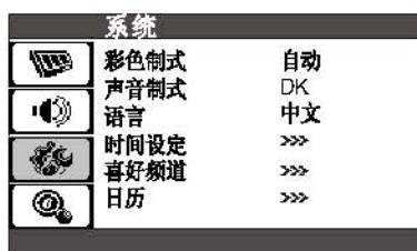
按“菜单”键进入主菜单, 按“节目”键选择“系统”菜单。按“音量”键或“确认”键进入, 再按“节目”键选择彩色制式、声音制式、语言、时间设定、喜好频道、日历, 选择后用“音量”键对彩色制式、声音制式、语言的参数进行适当调整。
