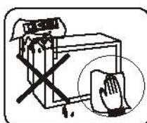
勿用酒精、氯水、稀释剂等清洗电视机表面，若确有必要，请用湿海绵或软布(可加少量中性洗涤剂)拧干后清洗，并切记在清洗前切断电源。
