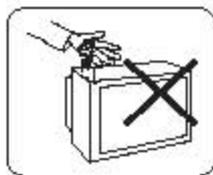
请勿将异物(如：铁屑、硬币、硬币等)插入机内，以防引起电路短路着火，损坏电视机。
