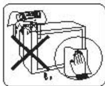
勿用酒精、强水、强溶剂等清洗电视机表面，若确有需要，请用海绵或软布(可加少量中性洗洁剂)的干布清洗，并切记在清洗前切断电源。
