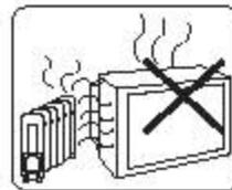
机内温度过高会引起电视机损坏，应保证电视机通风良好，切勿堵塞电视机散热孔。电视机应避免高温(如：暖气、火炉等处，并避免阳光直射)。
