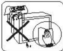
切勿用酒精、强水、稀料等清洗电视机外壳，若有污渍，可用湿海绵或软布(可加少量中性洗涤剂)拧干后擦拭，并切记在清洗前切断电源。
