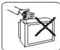
切勿将异物(如：铁屑、铜丝、硬币等)插入机内，以防引起短路而着火，损坏电视机。
