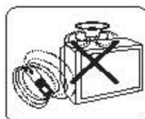
电视机应远离磁声带、电动机、变压器等磁性物品，以免引起磁色异常。
