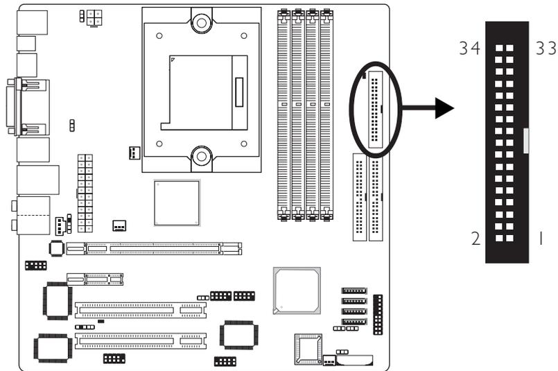
主機板上有一個軟碟機接頭，可連接一台標準軟碟機。此接頭有預防不當安裝的設計，安裝時必需將排線一端 34-pin 接頭的第一腳與主機板上軟碟機接頭的第一腳對應妥適，才能夠順利安裝。
