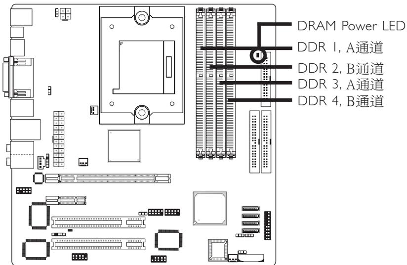
本主機板支援 DDR SDRAM DIMM 記憶體模組。DDR SDRAM (Double Data Rate Synchronous Dynamic Random Access Memory) 為 SDRAM 記憶體的一種，它在每一時脈的上升緣及下降緣都會進行資料的讀寫，以達成雙倍的資料傳輸效率。關於本主機板支援的記憶體的詳細規格，請參第一章。
