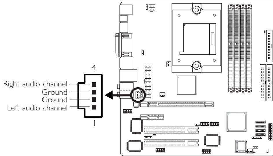
經由CD-in (J1) 音源輸入接頭可接收來自光碟機、電視諧調器或 MPEG 卡的音源訊號。
