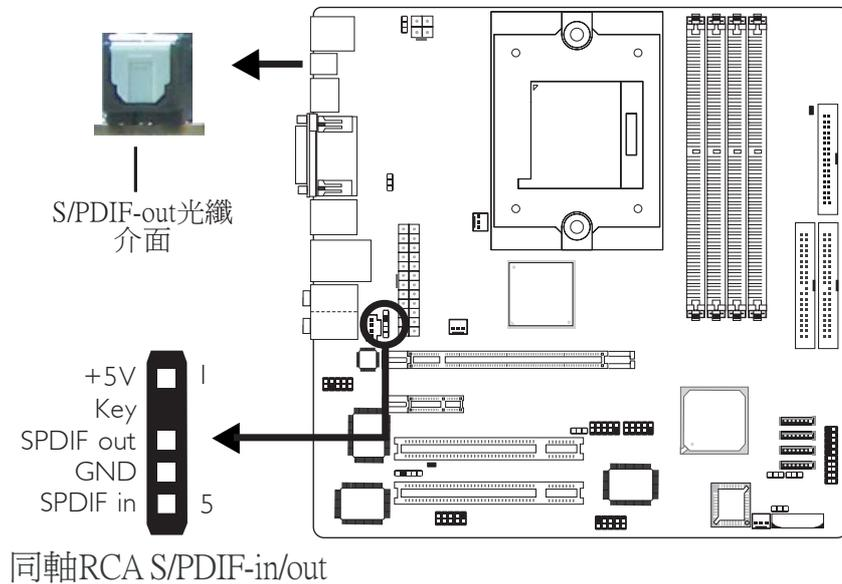
本主機板在CN7的位置有配置一個內建的S/PDIF-out光纖介面，另於J3的位置配置了一個同軸RCA S/PDIF-in/out連接接頭，S/PDIF埠通常用於連接音源輸出裝置。
