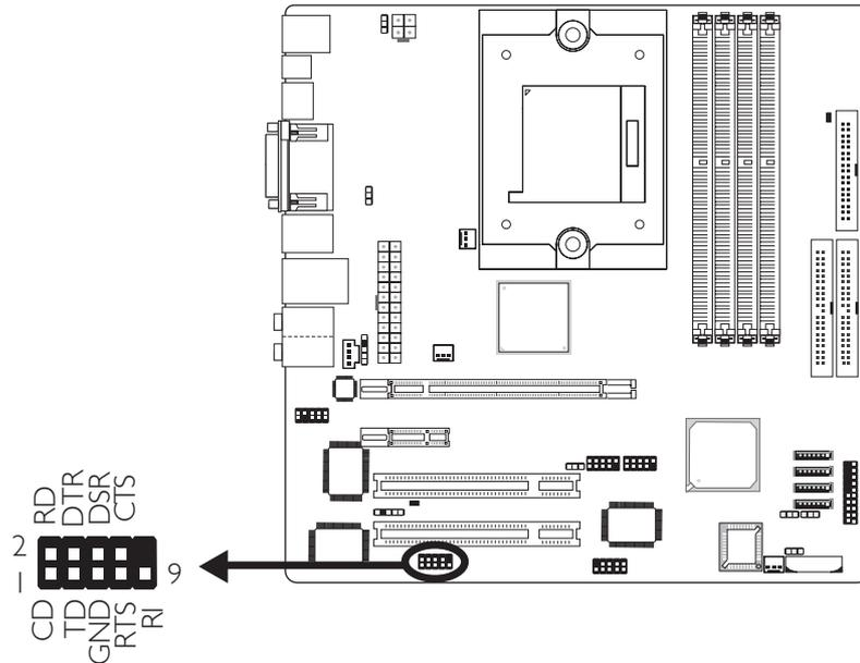
本主機板配置一個9-pin(J7)接頭，可接出一個外部串列埠。串列埠的排線作為選用品，需要您另外購置。串列埠出貨時即應黏貼在擋板上。請將擋板安裝在機殼上，然後將串列埠排線接頭連接至J7接頭，務必確認排線上的顏色條和pin1對齊。
