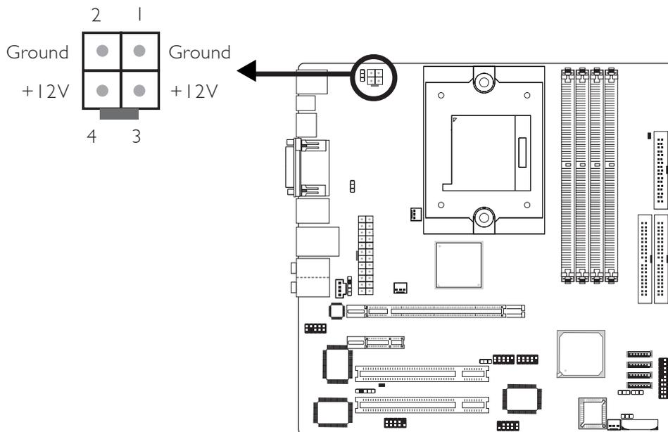
本主機板至少須使用300W 的電源。如果系統的負載較大時 (較多記憶體模組、介面卡及週邊裝置等)，可能需要更大的電源供應；**因此，使用400W或以上的電源供給器才可確保足夠的供電。**
