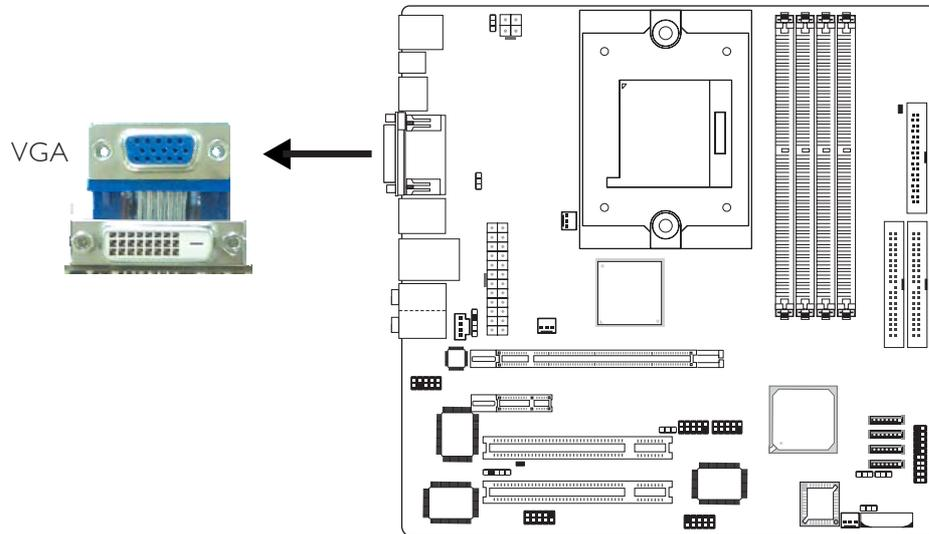
VGA埠用於連接VGA顯示器。請將顯示器的15-pin D-shell排線接頭連接至位於主機板CN11位置的藍色VGA埠，連接完畢後，緩慢擰緊接頭上的螺絲以固定好接頭。
