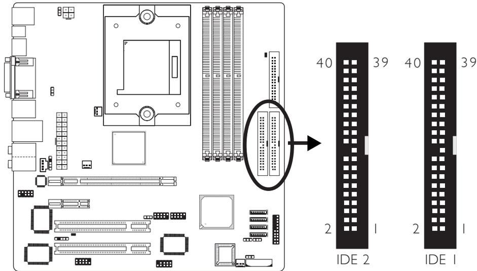
主機板提供兩個 PCIIDE 接頭，可安裝四台 Enhanced IDE (Integrated Drive Electronics) 硬碟。每一個 IDE 接頭皆有預防不當安裝的設計；安裝時必需將硬碟排線接頭的第一腳與主機板上 IDE 接頭的第一腳對應妥適，才能夠順利安裝。
