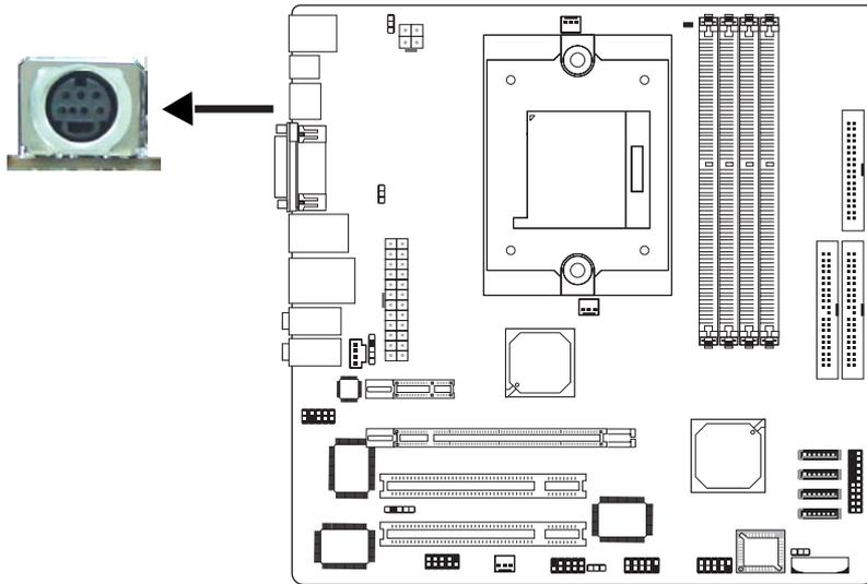
TV-out埠用於連接具備S-Video輸出、複合視訊輸出或Pr/Y/Pb component HDTV視訊輸出介面的TV。下表展示了其所支援的視訊輸出類型以及相對應的排線。
