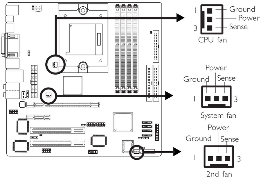
請將風扇接線接至主機板上的CPU 風扇接頭 (J30)。另有2nd fan (J32)與System fan(J31) 風扇接頭可用來連接額外的散熱風扇。散熱風扇可保持機殼內適當的空氣流通，防止CPU 及系統元件因過熱而受損。
