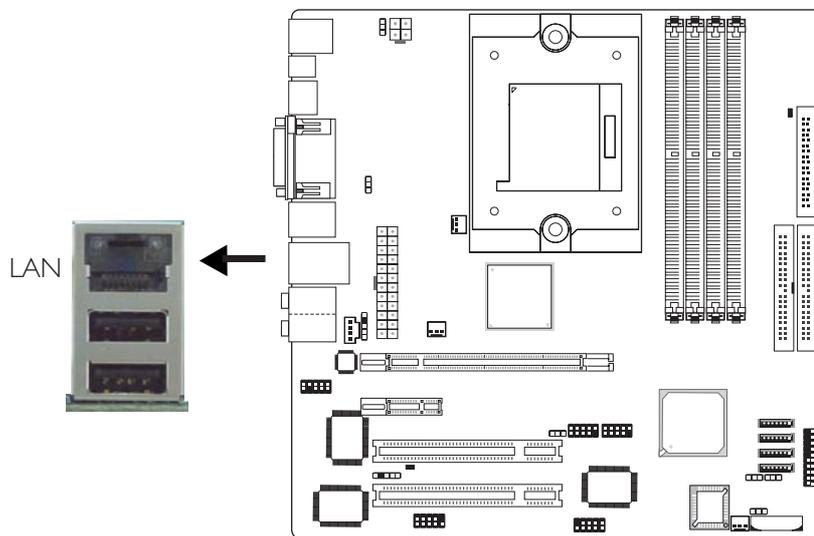
本主機板配置一個內建的網路埠(CN4)，透過網路集線器，可連上區域網路。
