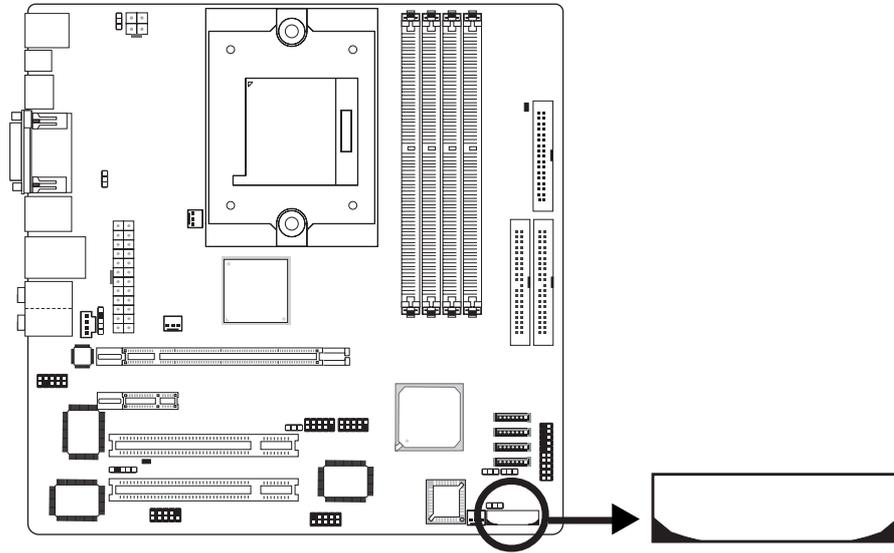
鋰離子電池作為輔助電源裝置，可於主電源關閉的情況下，為實時時脈和CMOS記憶體提供電源。
