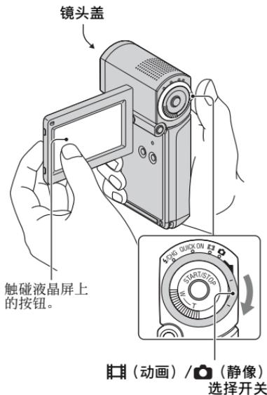
1 打开 LCD 液晶屏以开启摄像机电源。
