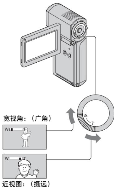
轻轻移动电动变焦控制杆可进行慢速变焦。较大幅度移动电动变焦控制杆可进行快速变焦。
