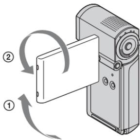
将 LCD 液晶屏与摄像机成 90 度打开 (①)，然后将其朝镜头一侧旋转 270 度 (②)。
