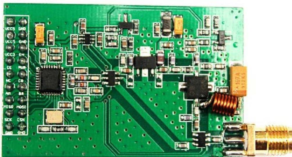
RF4432A 模块尺寸 (31mm X 53mm, 不包括 SMA 头尺寸)
