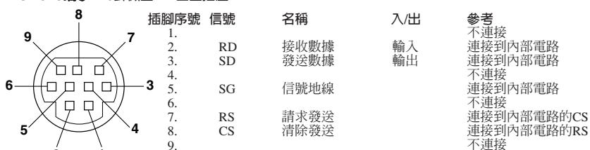
**RS-232C端子**：DIN-D-sub RS-232C轉接頭的9針D-sub凸型插頭（選購的附件：AN-A1RS）
