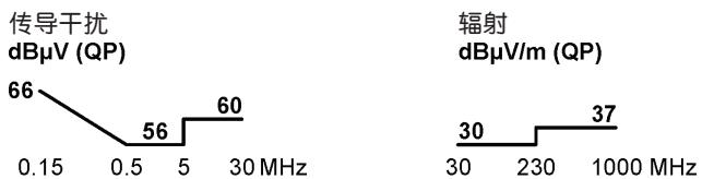
许可干扰限度符合适用标准EN 55011 B类；即在10 m距离处，为66-56/60 dB ( $\mu$ V)准峰值和30/37 dB( $\mu$ V/m)。
