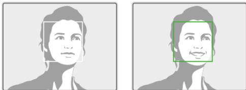
在“拍摄”模式中，选择 ▲ → [相机图标] → [微笑图标]。拍摄物笑得很开心时，相机更容易侦测到笑脸。
