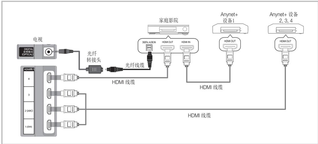
1. 使用HDMI线缆将电视机上的HDMI（1（DVI），2，3或者4）插孔与相应Anynet+设备的HDMI OUT插孔相连。
