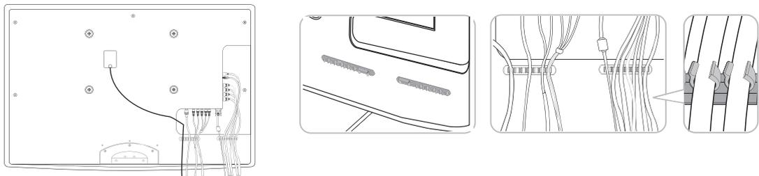
🔧 在装配线缆时，请不要过于用力拉扯线缆，这样会损坏连接端子。
