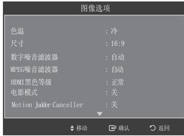
在PC模式下，您只能变更图像选项项目中的色温、尺寸和屏幕灼伤保护。
