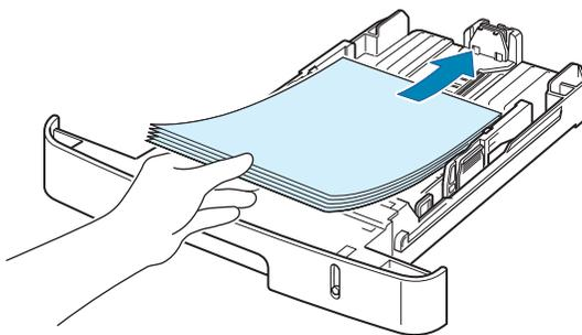
装入信头纸时，将图案面朝下装入。带徽标的纸张顶边应放在纸盘前部。
