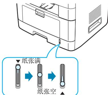
装纸时，请拉开纸盘，然后将纸张打印面朝下装入。
