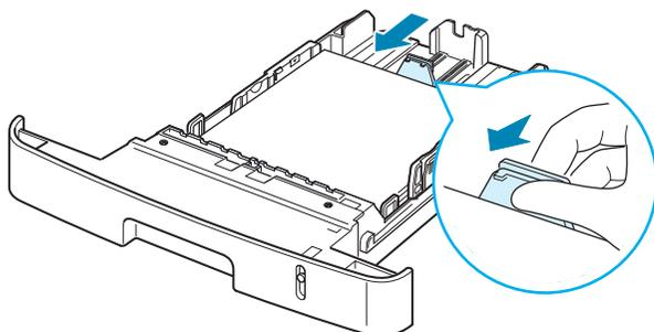
3 如图所示捏住宽度导板，向纸叠方向滑动，使其轻触纸叠边缘。
