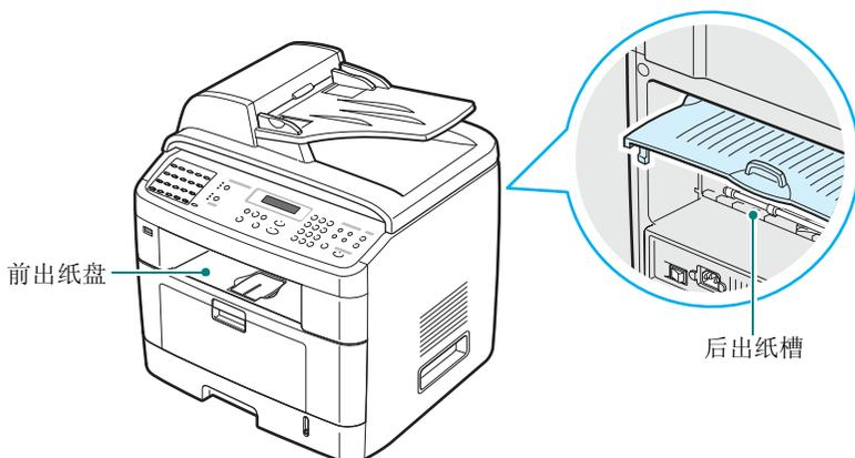
要使用前出纸盘，请务必关闭后门。要使用后出纸槽，请打开后门。
