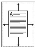
只有将文档放在文档扫描玻璃板上时，才可以使用这种特殊复印功能。如果在 ADF 中检测到文档，就不能进行 Auto Fit（自动调整）复印。
