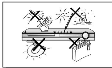
本机器避免接触到水分 (亦即花盆), 以及过热 (例如壁炉) 或是会产生强磁或是电场的设备 (例如扩音机等)。如果本机器故障, 将电源线 (缆线) 从交流电源拔下。您的光碟机不供工业使用, 而仅供个人使用。如果您的光碟机或是碟片存放于冷温环境里, 当移入温暖环境时, 则会产生结露现象。如果在冬天运送光碟机到室内, 则需要等大约二小时的时间, 以便待本机器在使用前达到室内温度。
