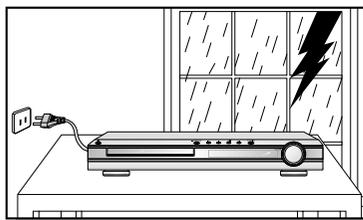
在打雷期间将电源从插座上拔下。雷电造成的电压尖峰会损害到本机器。
