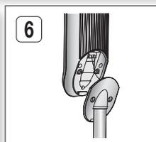
7. 将支架托架充分插入音箱的扣夹以让音箱竖立。
