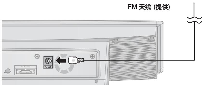
1. 将提供的 FM 天线连接到 FM 天线插孔。
