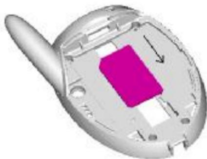
將電池放回手機後部，首先將電池底部的凸片推入相對應卡槽中，然後朝著手機後部向下推電池並鎖牢，
