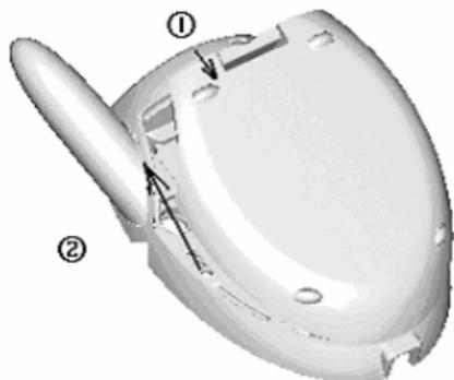
按下圖所示，將 SIM 卡插入凹片下，卡的斜角對準凹片的斜角，卡的金屬面朝向手機。
