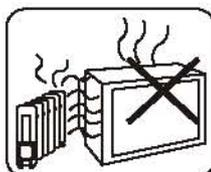
机内温度过高易引起电视机损坏，应保证电视机通风良好，切勿堵住电视机散热孔。电视机应远离热源(如：暖气、火炉等)处，并避免阳光直射。
