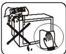
勿用酒精、氨水、稀释剂等清洗电视机表面，若确有需要，请用湿海绵或软布(可加少量中性洗涤剂)拧干后清洗，并切记在清洗前切断电源。
