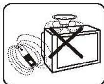
电视机应远离扬声器、电动机、变压器等磁性物品，以免引起彩色异常。
