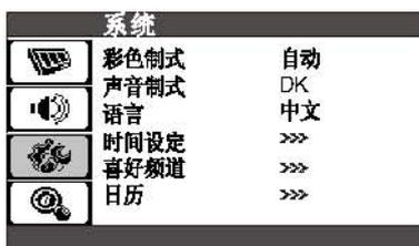
按“菜单”键进入主菜单，按“节目”键选择“系统”菜单。按“音量”键确认，再按“节目”键选择彩色制式、声音制式、语言、时间设定、喜好频道、日历，选择后用“音量”键对彩色制式、声音制式、语言的参数进行适当调整。
