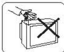
切勿将异物(如:铁屑、铜管、螺钉等)插入机内，以防引起电路短路着火，损坏电视机。
