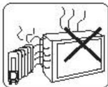
机内温度过高易引起电视机损坏，应保证电视机通风良好，切勿堵塞电视机散热孔。电视机应远离热源(如:暖气、火炉等)处，并避免阳光直射。
