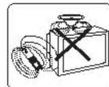
电视机应远离高温源、电动机、变压器等磁性物品，以免引起彩色异常。
