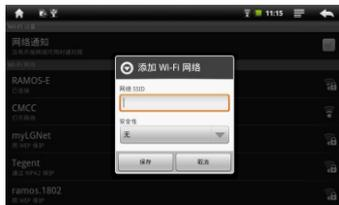
用户在上述界面设置好网络SSID和安全性后可添加某目标网络到WiFi网络列表中。在WiFi网络列表中点击任一网络，在通过安全验证（无线密码等）后点击连接即可将此网络设置为当前上网网络。
