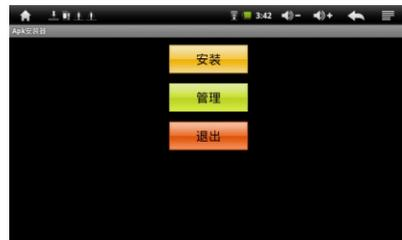
**安装** 用户下载需要的APK安装程序于本机后，点击此选项可进入APK程序安装界面。
