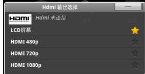
HDMI输出时，480、720、1080三数值对应输出的画面质量，数值越大输出越清晰。
