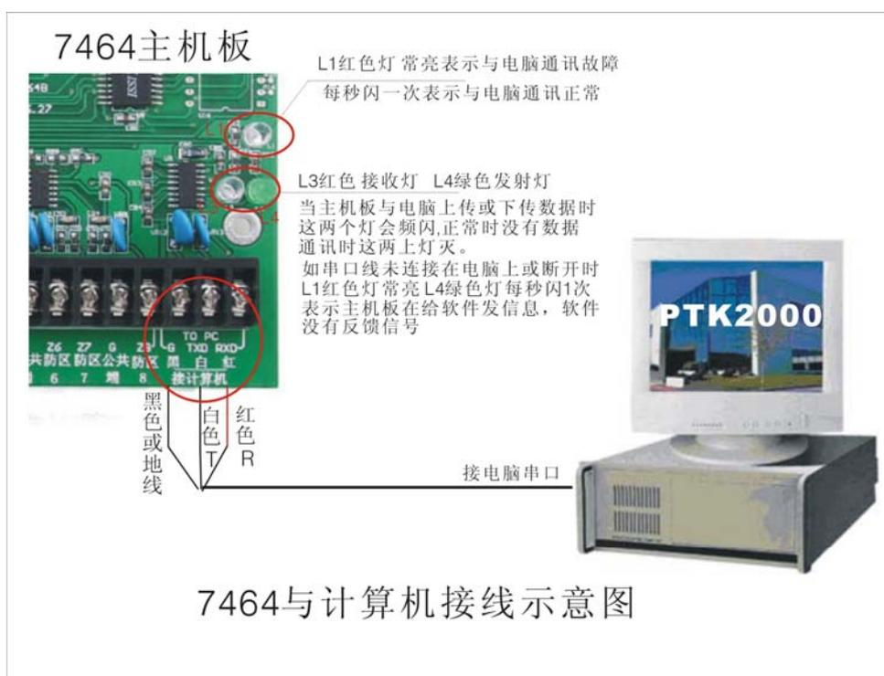
通过总线与中心软件管理系统的连接方式：将 7464 主板上标有“接计算机”的三芯端口与计算机的串口连接（接口线作为中心管理软件的附件统一配备）。
