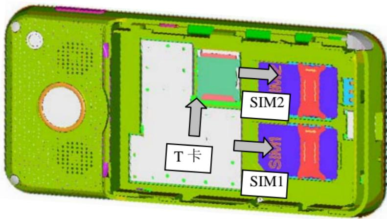
将 SIM 卡金属面朝下，轻轻滑入固定位置。
