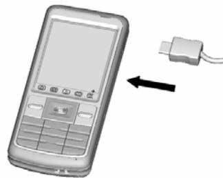
如果充电时是关机状态，屏上显示充电动画。如果是开机状态，屏幕右上角的电量指示符号会循环闪动。
