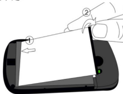
5. 如图示，将手机后盖对准槽口推入，直至其卡定。
