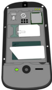
4. 如图示，将电池上的金属触点与电池槽的金属触点对齐。然后将电池装入电池槽，使其卡定。
