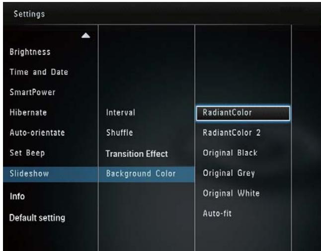
→ 如果您选择 [自动适合]，则数码相框将拉伸照片以填充整个屏幕，造成画面失真。
