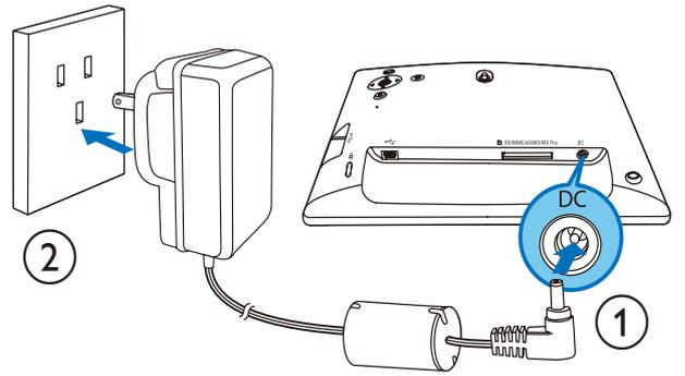
2 将电源线连接到电源插座。
