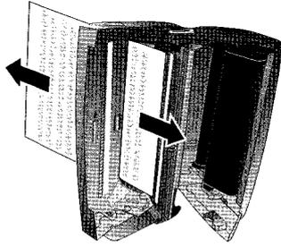
5 关闭扫描器盖及自动进稿器壳体。两个支撑板均应牢固卡入就位。
