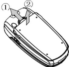
的卡锁①向上拉, 然后拉起电池盖②, 取出电池。
