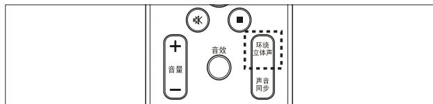
反复按 环绕立体声 可在提供的环绕声模式之间循环切换。
