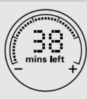
Trong vài lần sạc đầu tiên, thời gian hoạt động hiển thị được ước lượng một cách tương đối. Khi đã xác định được cách sử dụng máy của bạn, thời gian này sẽ được tự động điều chỉnh đúng với thời gian hoạt động thực sự của máy.
