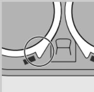
**5** Kembalikan rangka penahan ke dalam unit pencukur, tekan roda dan putarkannya menurut arah jam.
