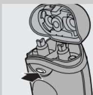
**1** ปิดสวิตช์เครื่องโกนหนวด ถอดปลั๊กออกจากเด้ารับ และตัวเครื่อง
