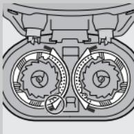
**4** 取下剃须刀头并换上新的剃须刀头，更换时，保证凸起完全卡入剃须刀头部件的凹壁中。
