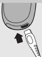
1 將電源線的一端插在電鬍刀機體的電源插孔中。
