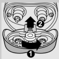
**4** 取下剃须刀头，在剃须刀头部件上装上新的剃须刀头。
