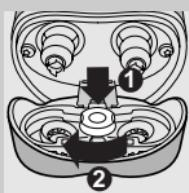
**4** 取出電鬍刀刀頭，然後在電鬍刀組裝上新的刀頭。
