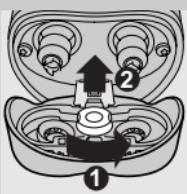
**1** 打开剃须刀头部件，逆时针方向转动轮轴 (1) 并取下固定架 (2)。
