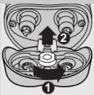
**1** 打開電鬍刀組，以逆時針方向轉動轉盤 (1)，拆下固定架 (2)。
