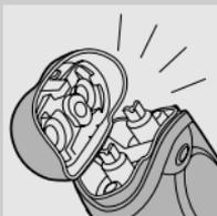
**6** 再一次打開電鬚刀組並保持開啓，讓電鬚刀完全晾乾。
