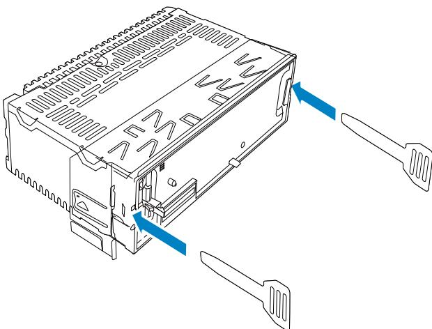
**4** 将机套装入仪表盘，向外弯曲卡舌以固定机套。
