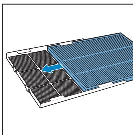
**8** 将预过滤网放回产品内部。然后将所有挂钩正确连接到产品上。
