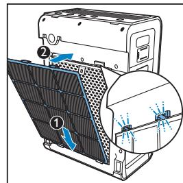
**6** 除去新的多功能过滤网上的所有包装材料。
