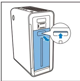
**5** 放回新的加湿滤网，然后将加湿滤网托盘滑入产品。
