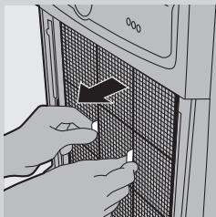
**2** 将手指放在侧面板的凹处，然后面向您的方向轻轻拉出前面板的下半部分。提拉面板顶部的挂钩，将其从产品顶部拉出来。
