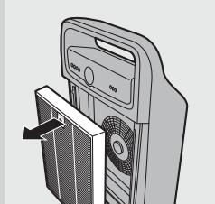
**4** 要卸下过滤网 2（新的家用过滤网），请抓住其拉片，然后朝您的方向拉动。
