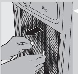
**2** 要卸下预过滤网，请抓住两个凸缘，然后朝您自己的方向拉动过滤网。
