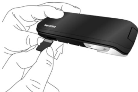
**如需取出 Micro SD 卡**，按压 Micro SD 存储卡解锁，使其从卡槽中弹出。
