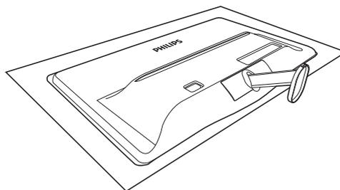
2. 用双手拿住底座支撑臂，用力将底座支撑臂插入底座支撑柱。
