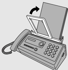
**注释：**无论何时，只要显示屏上交替显示右侧的信息，请立即检查打印纸。如果纸盘空了，请加纸。如果纸盘中有纸，请取出然后重新放入。完成上述操作之后，请按下
