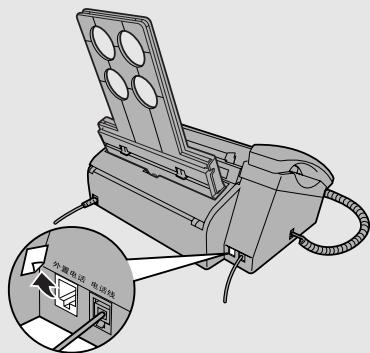
**2** 将分机电话线连接至外置电话插孔。
