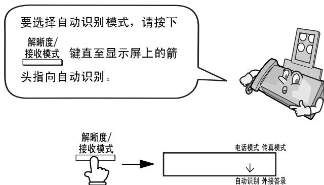
将接收模式设定为自动识别后, 传真机将在两次振铃后自动应答所有呼叫。在应答呼叫后, 传真机会监控线路约五秒钟, 以查看是否正在发送传真信号音。
