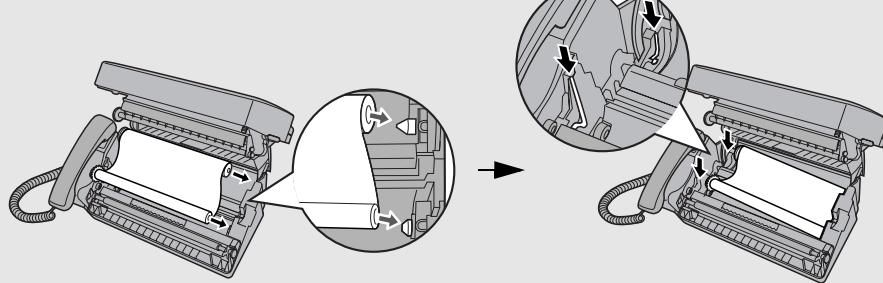
**5 转动前面的齿轮，直至胶片绷紧。然后，合上操作面板（按下操作面板两侧，确保其卡入到位）。**
