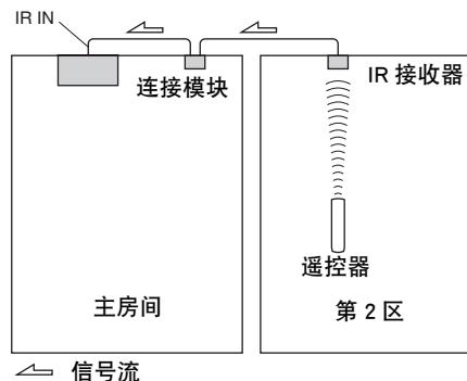
按下图所示，将连接模块的迷你插头连线与 AV 接收机的 IR IN 插孔相连接。
