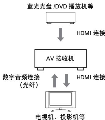
2. 使用数字光缆连接电视音频输出至 AV 接收机的 **OPTICAL IN 2** 接口。
